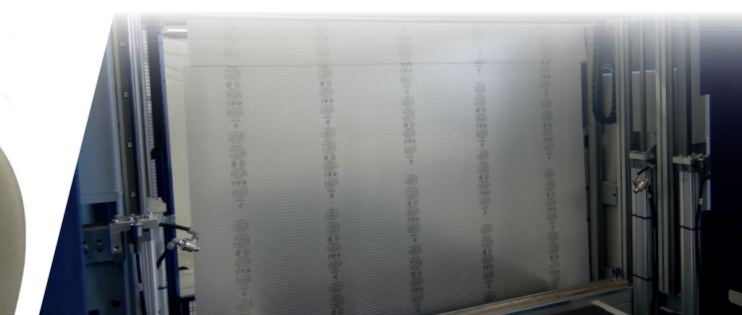
BARRA SALDANTE / SEALING BAR Saldatura automatica del film protettivo sul prodotto prima dell'ingresso nella fasciatrice orizzontale. Disponibili 3 lunghezze differenti (750/1500/2000 mm che corrispondono alle medesime larghezze di bobina disponibili). Automatic welding of the protective film on the product before entering the horizontal wrapper 3 different length available (750/1500/2000 mm which correspond to the same available reel widths).
